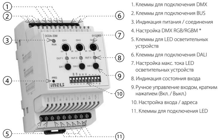
1. Клеммы для подключения DMX
