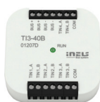
TI3-40B Teplotní vstup, 4 kanály
