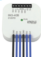
IM3-40B Jednotka binárních vstupů, 4 kanály
