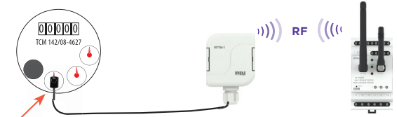
Размещение датчика на магнитном счетчике воды
