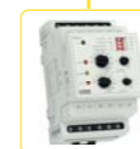
TER-4 Široký a přesný rozsah nastavení -40 až +110 °C v 10-ti rozsazích v jednom přístroji, jemné dostavení teploty, 2 vstupy pro NTC senzor, 2 výstupy 16 A přepínací, doplňující funkce (paměť, hystereze, indikace vadného senzoru) napájení: AC 230 V nebo AC/DC 24 V (galv. oddělené). str. 134
