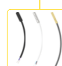
TC, TZ, Pt100 Externí teplotní senzory pro termostaty v délkách 3 m, 6 m, 12 m - TC/TZ: termistor NTC 12 kΩ/25 °C - Pt: článek Pt100 (pouze TER-3G). str. 145
