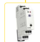
TER-7 Kontrola oteplení vinutí motoru v pásmu daném odporem zabudovaného PTC termistoru (1.8-3.3 kΩ), doplňující funkce (paměť, reset), výstupní kontakt 2x 8 A přep., napájení: AC/DC 24-240 V. str. 133
