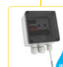
TEV-1 Termostat s „mrtvou zónou“ nastav. rozsah -20 až +20 °C, ochrana proti zamrznutí, provedení vodotěsné IP65. str. 138
