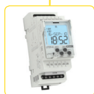
TER-9 2 teplotní vstupy, 2 výstupy 8 A přepínací, 6 funkcí, vestavěné spínací hodiny, podsvětlený LCD, galvanicky odd. napájení AC 230 V nebo AC/DC 24 V, 2 MODUL. Teplotní rozsah: -40 °C až +110 °C. str. 136
