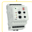
TER-4 Široký a přesný rozsah nastavení -40 až +110 °C v 10-ti rozsazích v jednom přístroji, jemné dostavení teploty, 2 vstupy pro NTC senzor, 2 výstupy 16 A přepínací, doplňující funkce (paměť, hystereze, indikace vadného senzoru) napájení: AC 230 V nebo AC/DC 24 V (galv. oddělené). str. 134
