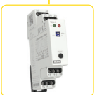
TER-7 Kontrola oteplení vinutí motoru v pásmu daném odporem zabudovaného PTC termistoru (1.8-3.3 kΩ), doplňující funkce (paměť, reset), výstupní kontakt 2x 8 A přep., napájení: AC/DC 24-240 V. str. 133
